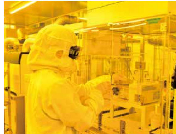
※クリーンルームは紫外線カットのため、イエローライトを使用しています
